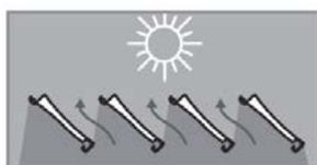
Protection solaire maximale et ventilation naturelle.
